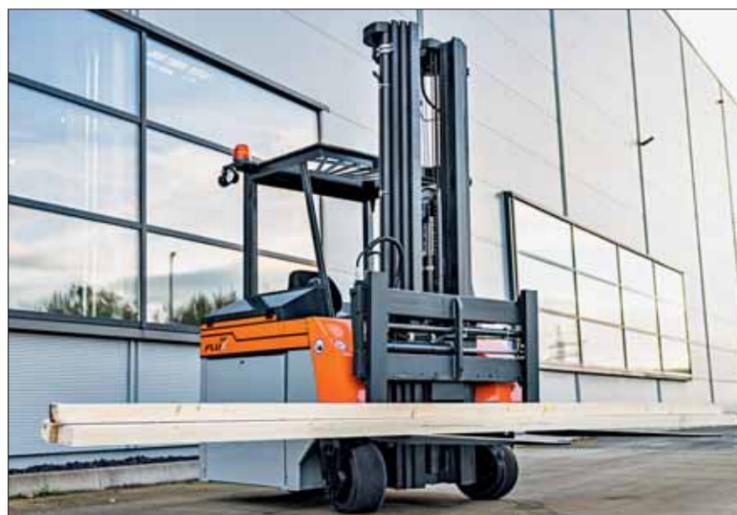
Die neue „Flux“-Generation deckt den kombinierten Paletten- und Langguttransport in einem Fahrzeug ab, ideal für den Holzbereich. Der „Flux 30“ ist für den Innen- und Außenbereich geeignet
